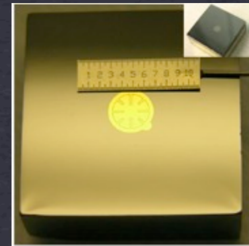
Dual-anode CZT detectors: 1 \times 2 \times 2 \text{ cm}^3 .
